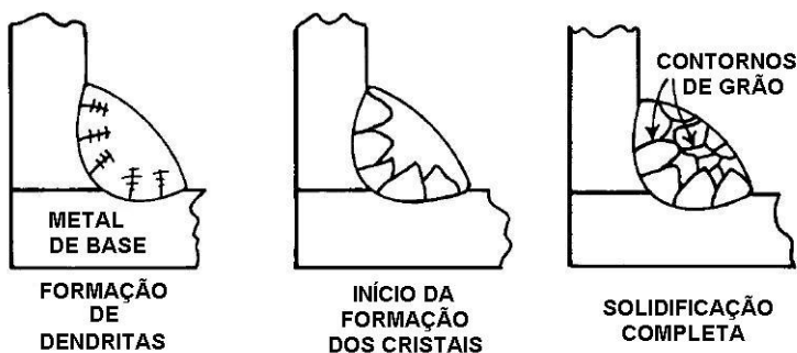
Figura 8 - Processo de solidificação de uma junta soldada
